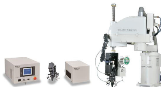
Obr. 5 Laserový pájecí systém (vlevo přístroj a pájecí hlava) Obr. 6 Laserový pájecí robot typu SCARA (vpravo)
